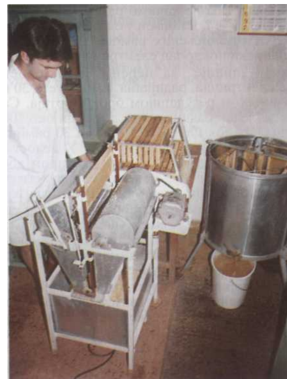
Сл. 65. Једноставна линија за цеђење меда: отклапач саћа, сталак за рамове и центрифуга
